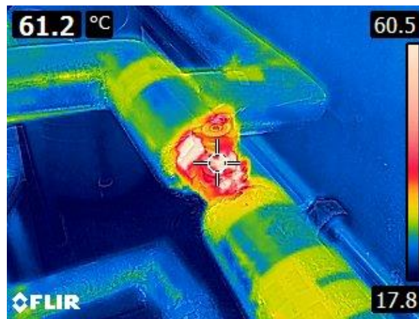
4 pav. Dvieigio reguliavimo vožtuvo termovaizdas Šaltinis: sudaryta autorių
