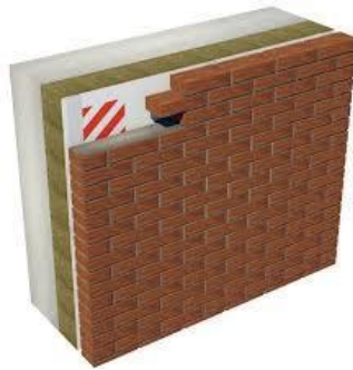
3 pav. Trislukšnės mūro sienos su akyto betono blokeliais siena
