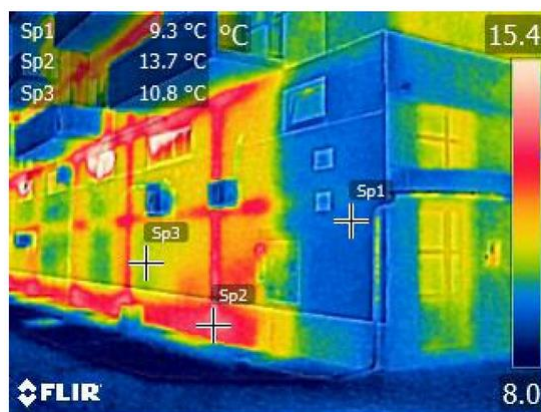
1 pav. Gerai matomų konstrukcinių elementų, taip pat šildomos ir nešildomos erdvės pavyzdys [6]
