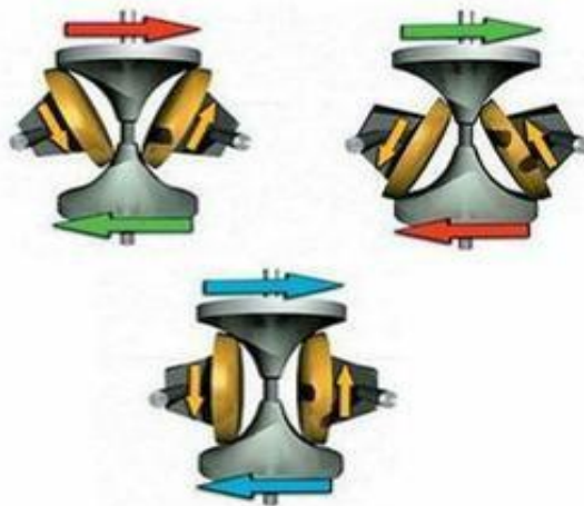
6 pav. Toroidinio CVT veikimas [3]
