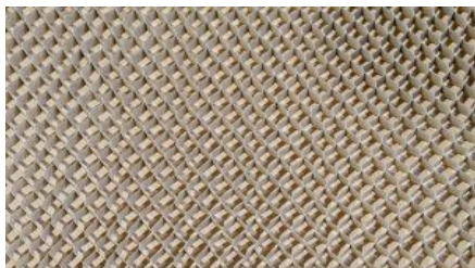
2 pav. Laminuotas korinis užpildas
