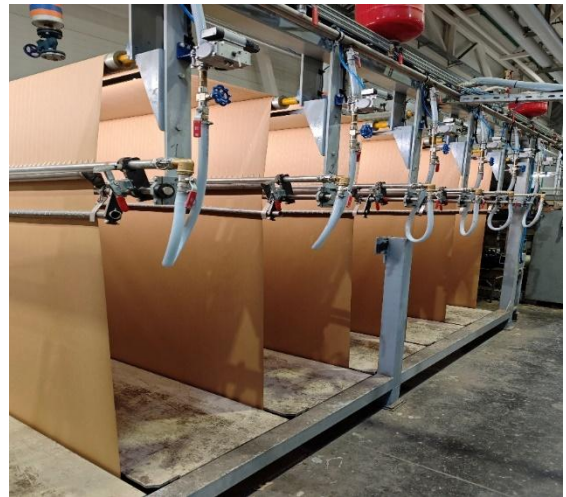
6 pav. Vamzdelinis klijų padengimo įrenginys
