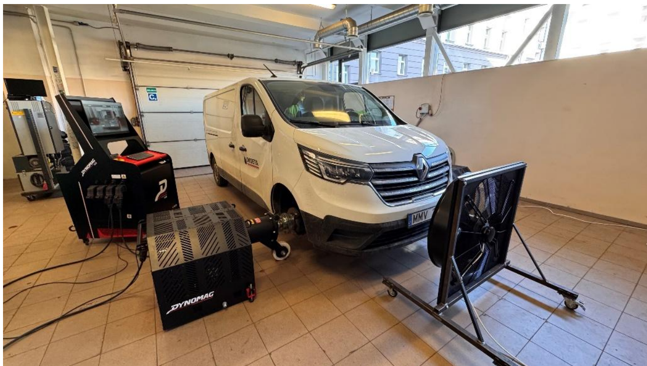
9 pav. Sumontuotas Dynomag Hub DNH02.000 4WD – galios matavimo stendas.
