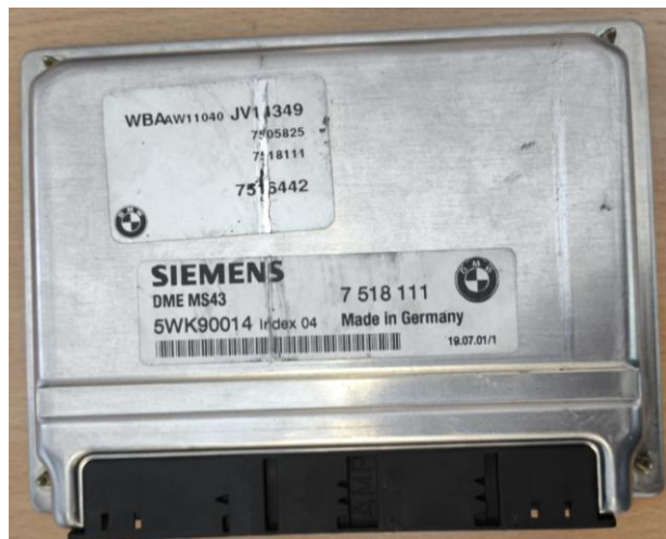
2.7 pav. Siemens MS43 elektroninis variklio valdymo blokas.
