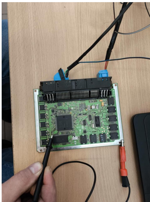
2.8 pav. Siemens MS43 valdymo bloko įrašymo režimo (boot mode) inicijavimas trumpinant kontaktą programavimui (JM Garage).
